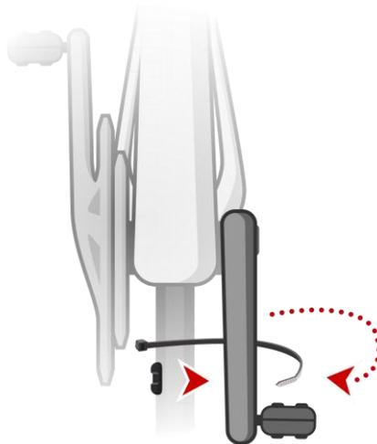
**Tipp:** Stellen Sie sicher, dass die einzelnen Teile des Kadenz-/Geschwindigkeitsmessers korrekt an Ihrem Fahrrad angebracht sind. Der Speichenmagnet sollte den größeren Teil des Kettenstrebensensors passieren und der Pedalmagnet die Spitze des Sensors.
