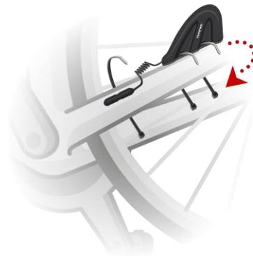
2. Bringen Sie den Speichenmagneten an einer der Speichen Ihres Fahrrads an. Der Magnet sollte in Richtung der Kettenstrebe zeigen, an der Sie den Kettenstrebensensor befestigt haben.
