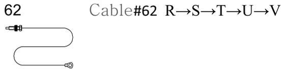
4. V: Befestigen Sie das Kabelende mit einer Schraube M10\*70 (47), zwei M10 Unterlegscheiben (57) und einer Kontermutter M10 (59) am mittleren Rahmen.
