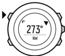
Der Kompass schaltet sich nach einer Minute in den Energiesparmodus. Mit [Start Stop] können Sie ihn reaktivieren.
