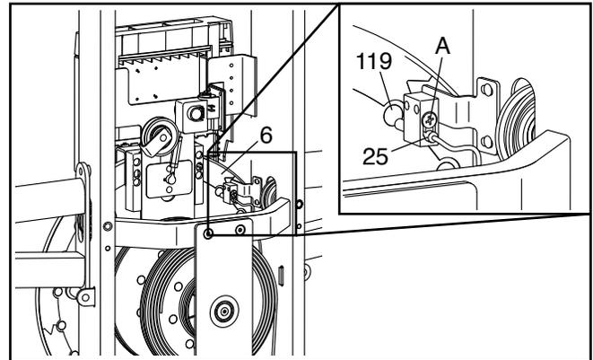
Puis, faites tourner le Disque de Résistance (6) jusqu'à ce qu'un Aimant (119) soit aligné avec le Capteur Magnétique (25). Faites glisser légèrement le Capteur Magnétique vers ou à l'opposé de l'Aimant. Puis, resserrez la vis (A).
