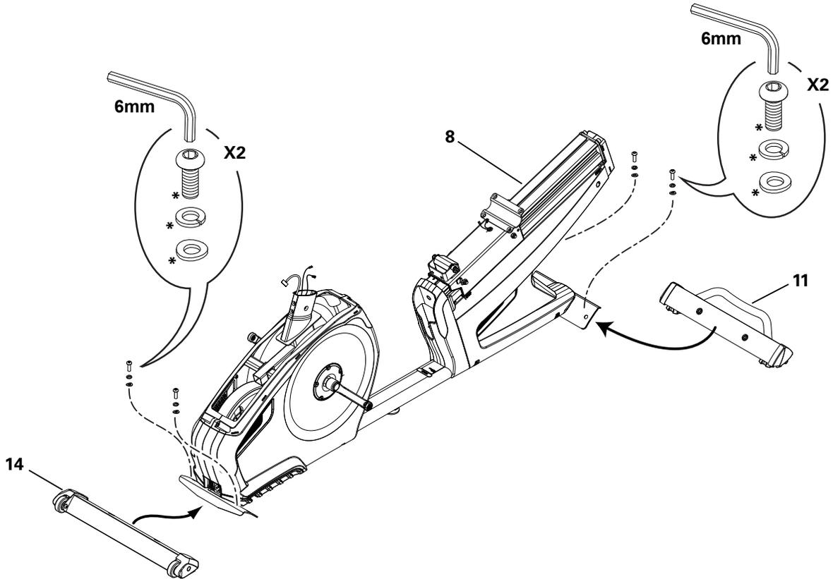
**1b. Setzen Sie die Endabdeckung der Sitzschiene auf den Rahmen.**
