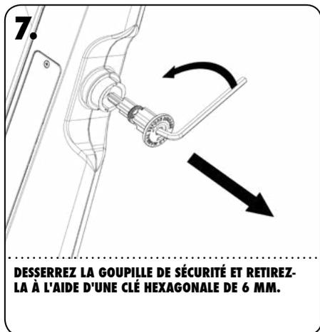
**DESERREZ LA GOUPILLE DE SÉCURITÉ ET RETIREZ-LA À L'AIDE D'UNE CLÉ HEXAGONALE DE 6 MM.**
