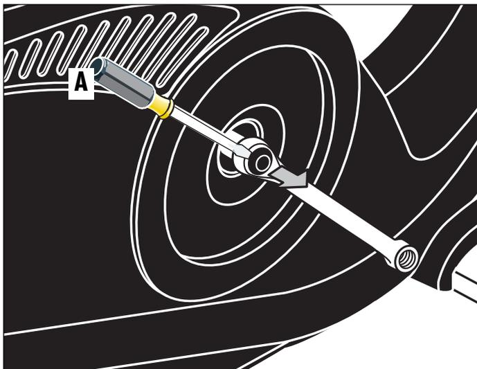
Zum Abziehen des Pedalarms entfernen Sie zuerst die Schutzkappe und Schraube (A). Halten Sie den Pedalarm fest und drehen Sie eine Schraube M12 (gehört nicht zum Lieferumfang) in die Gewindeöffnung (B). Nach einigen Umdrehungen können Sie den Pedalarm abnehmen (C).
