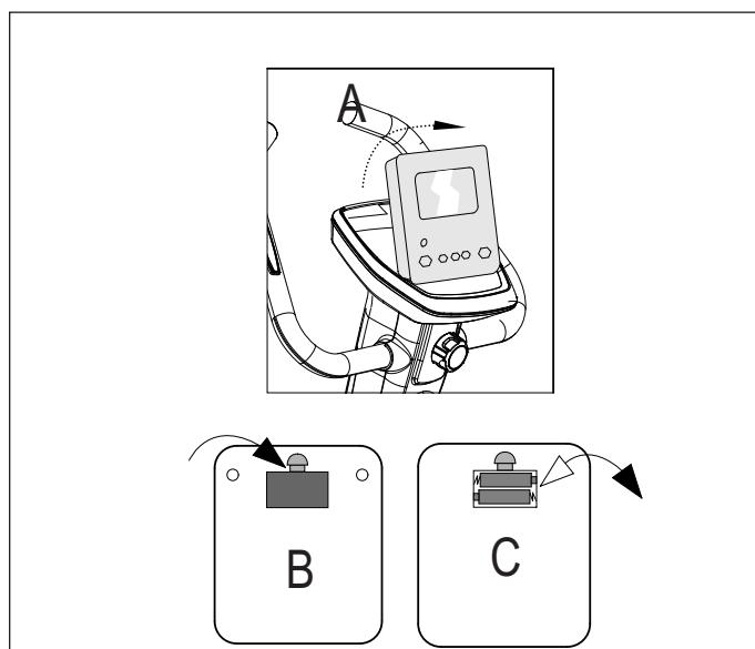
Eine schwache oder erloschene Computeranzeige macht einen Batteriewchsel erforderlich. Der Computer ist mit zwei Batterien ausgestattet. Nehmen Sie den Batteriewchsel wie folgt vor:
