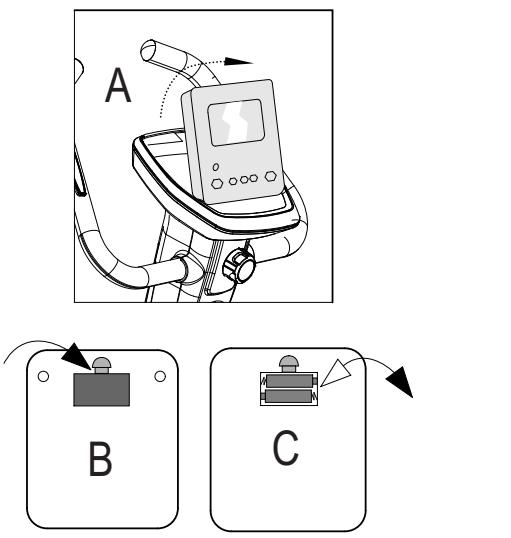
Eine schwache oder erloschene Computeranzeige macht einen Batteriewechsel erforderlich. Der Computer ist mit zwei Batterien ausgestattet. Nehmen Sie den Batteriewechsel wie folgt vor:
