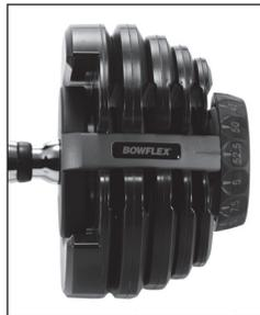
3. Sie haben die Hantelstange aus der Halterung genommen und versuchen nun vorsichtig, das Einstellrad zu drehen. Dies sollte nicht möglich sein. Ein Arretierstift im Mechanismus sperrt das Rotationssystem, sobald das Gerät aus der Halterung genommen wird. Führen Sie diesen Test für alle Einstellräder aus.
