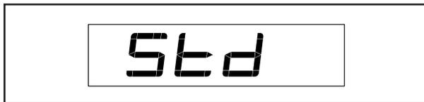
**Displayprüfung** – Dieser Bildschirm ist Wartungstechnikern zugeordnet, damit sie bestimmen können, ob das Display richtig funktioniert.
